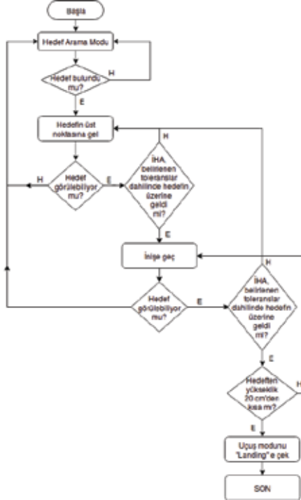
Şekil 1 Kontrol Algoritması Blok Diyagramı
