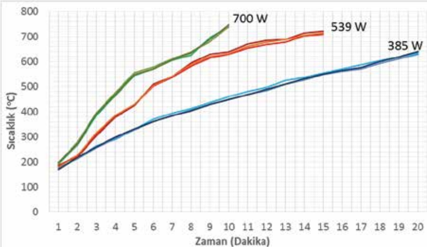
Şekil 2. Mikrodalga Destekli Isıtmada Güç Seviyesinin Belirlenmesi İçin Sıcaklık-Zaman Profilleri
