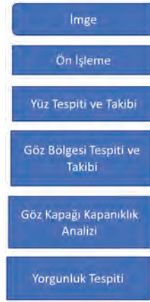
Şekil 1. Önerilen sürücü yorgunluk sisteminin blok şeması
