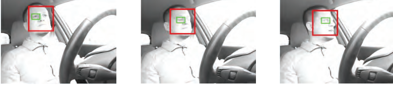
Şekil 4. Şekil 3’de bulunan yüz bölgeleri için göz tespit sonucu.
