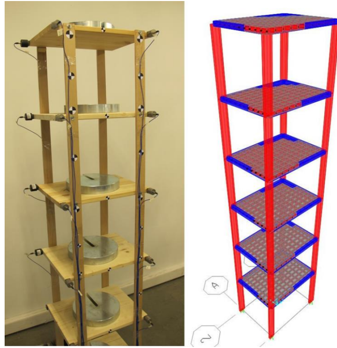
Şekil 3 Ölçekli 6 katlı bina modeli ve SAP2000 sonlu elemanlar modeli
