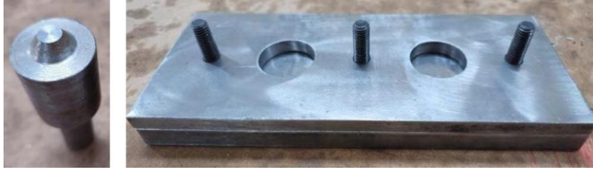
Şekil 3. Bu deneysel çalışma için tasarlanıp üretilen konik kaynak takımı ve bağlama aparatı
