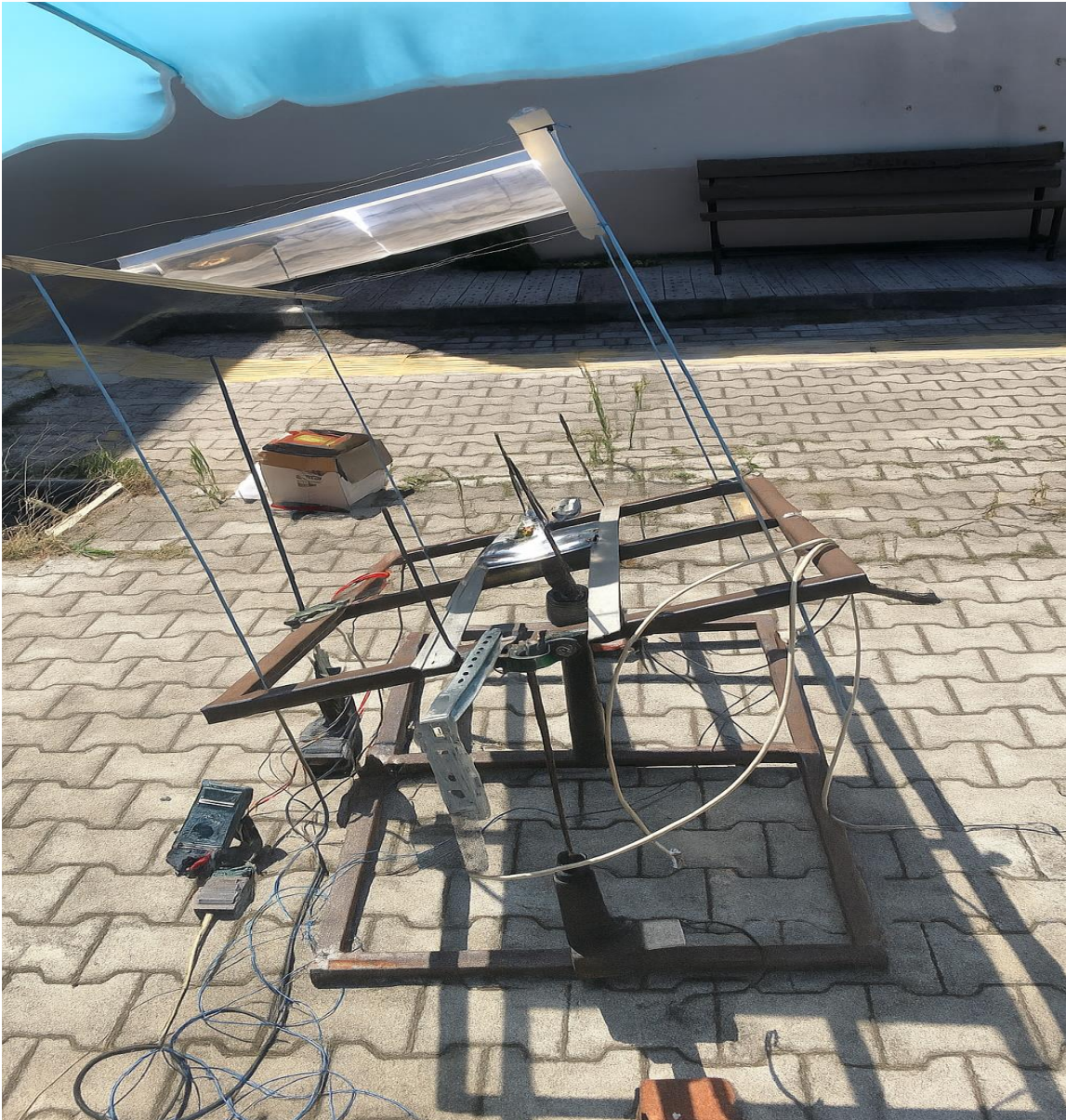
Şekil 2.1 Deney Düzenekinin Güneş Takip Sistemine Entegre Edilmiş Görüntüsü
