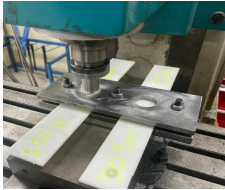
Şekil 4. POM kaynak numunelerinin, tezgah tablasına bağlama aparatı ile sabitlenmesi
