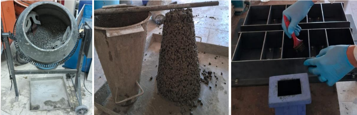
Şekil 2.1. Numune Hazırlama Süreci (a) Pomza katkılı beton karışımının mikserde hazırlanması, (b) Kıvam tayini için slump testi uygulanması, (c) Numune kalıplarının kalıp yağı ile hazırlanması.
