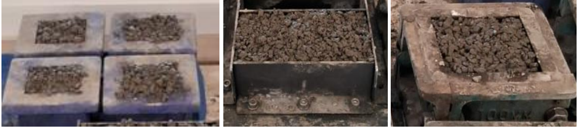
Şekil 2.2. Farklı boyutlardaki numune kalıpları: (a) 7×7×7 cm küp kalıp, (b) 20×10×8 cm dikdörtgen prizma kalıp, (c) 10×10×10 cm küp kalıp.
