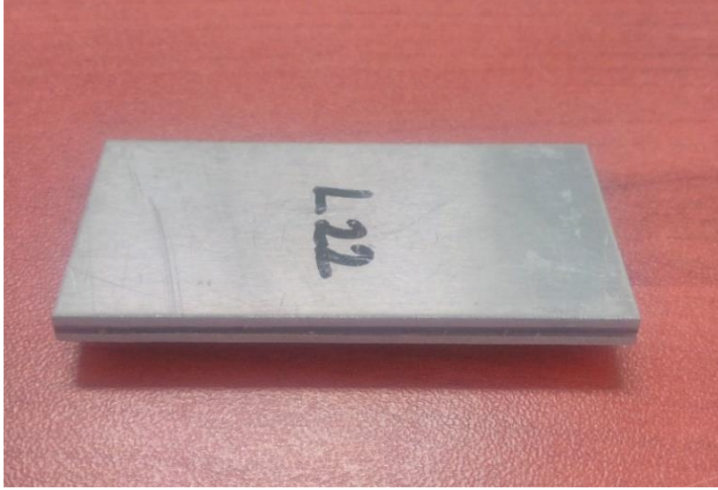
Őekil 3. Sandviç kompozit levha numunesi
