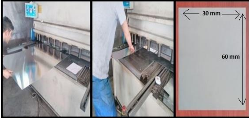
Şekil 1. Sac levhaların giyotin tezgâhta kesilmesi
