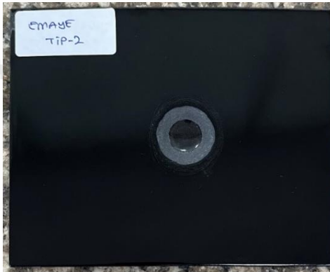
Şekil 4.7: Kolay temizlenebilir özellikli emayeye ait pirolitik özellik test sonucu.
