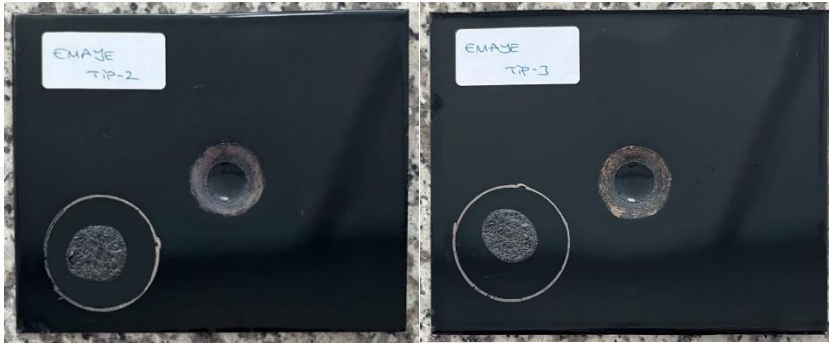
Şekil 4.4: Kolay temizlenebilir ve pirolitik özelliğe sahip emayelerin ketçap testinin ardından yüzey görüntüsü.
