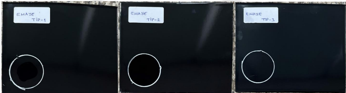
Şekil 4.2: Sırasıyla asit mukavim, kolay temizlenebilir ve pirolitik özelliğe sahip olan emayelerin asit test sonucu.
