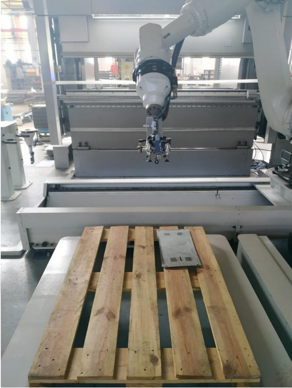
Şekil-2 Endüstriyel robot ile palet üzerine istiflenmiş parçaların alınması ve abkant pres beslemesi
