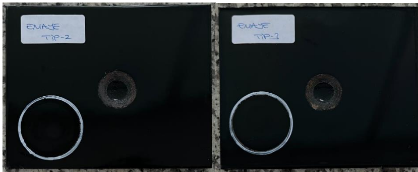
Şekil 4.5: Kolay temizlenebilir ve pirolitik özelliğe sahip emayenin ketçap testinin ardından tahta parça ile kazınan yüzey görüntüsü.
