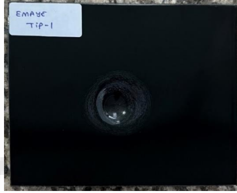
Şekil 4.6: Asit mukavim özellikli emayeye ait pirolitik özellik test sonucu.
