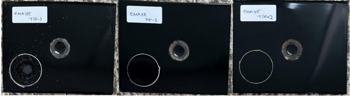
Şekil 4.3: Sırasıyla asit mukavim, kolay temizlenebilir ve pirolitik özelliğe sahip emayelerin lityum nitrat test sonucu.
