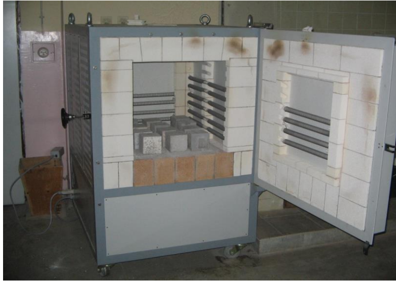
Şekil 4.9. Yüksek sıcaklık testlerinde kullanılan fırın
