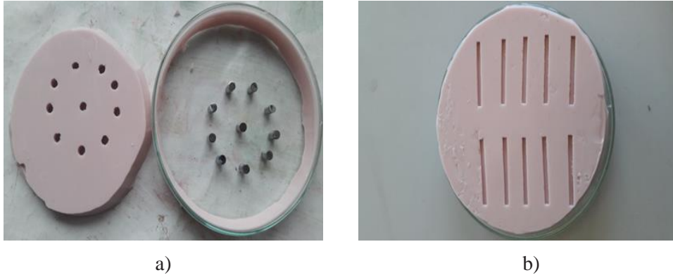
Şekil 2.1. ISO 4049 standardına göre hazırlanmış silikon kalıplar a) Basma testi için hazırlanan kalıp b) 3 nokta eğilme testi için hazırlanan silikon kalıp
