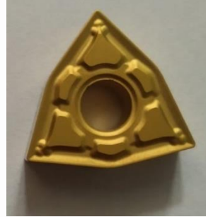
Şekil 3: Tormalama işleminde kullanılan elmas uç
