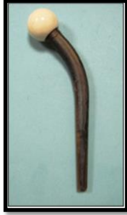
Şekil 8. Karbon / cam elyaf katkılı alümina başlıklı ve kompozit gövdeli bir kalça protezinin görüntüsü [9].
