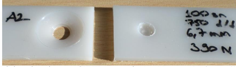
Şekil 11. Çekme deneyi sonrası SKNK numunesi-A2 (FSSW sample after tensile test-A2)
