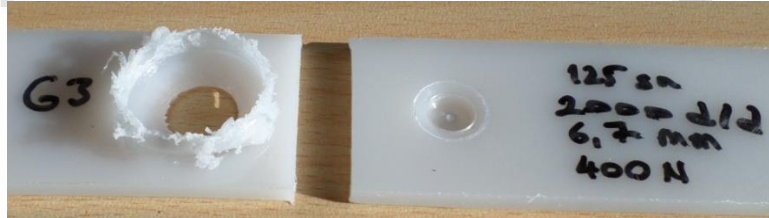
Şekil 13. Çekme deneyi sonrası SKNK numunesi-G3 (FSSW sample after tensile test-G3)
