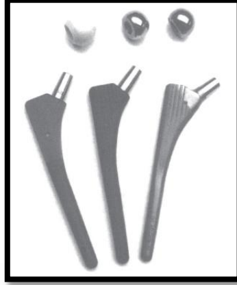
Şekil 6. Hidroksiapatit kaplamalı ve kaplamasız, karbon fiber takviyeli termoplastik kalça protezi [7]
