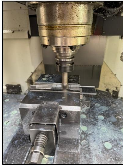
Şekil 4. PC kaynak numunelerinin tezgah tablasına bağlama aparatı ile sabitlenmesi ve kaynaklı bağlantıların gerçekleştirilmesi
