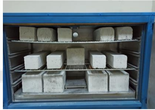
Şekil 3. Etüve yerleştirilen numuneler.
