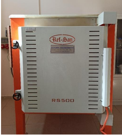
Şekil 4. Numunelere sıcaklık etkilerinin uygulandığı fırın.
