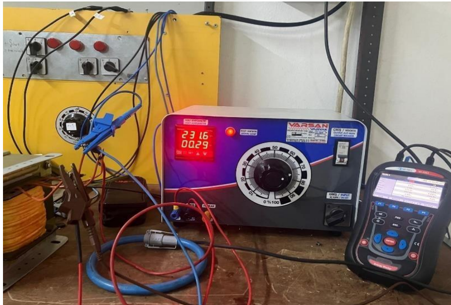
Şekil 4. Boşta Deney Düzeneği
