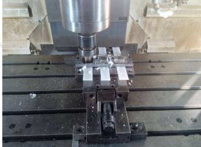
Şekil 4. Deneyisel çalışmada kullanılan sürtünme karıştırma nokta kaynağı numune bağlama aparatı
